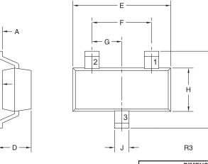
LEAD CODE: 1) Gate 2) Source 3) Drain
