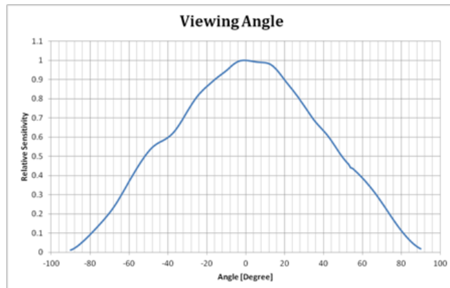
Figure 4.2 ALS Sensitivity vs. Angular of Incidence
