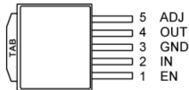
5-Pin TO-252 (D-Pak) Adjustable Voltage (D) MIC29152
