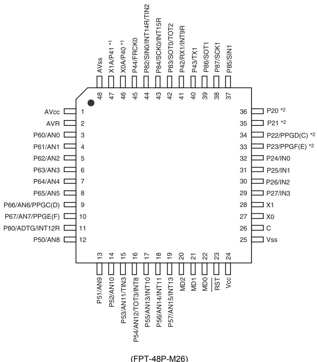
\*1 : MB90F362E/TE, MB90362E/TE, MB90F367E/TE, MB90367E/TE : X0A, X1A
