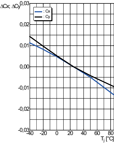
Chromaticity Coordinate Shift 7) page 20 Farbortverschiebung 7) Seite 20 \Delta Cx, \Delta Cy = f(T_j); I_F = 30\text{ mA}
