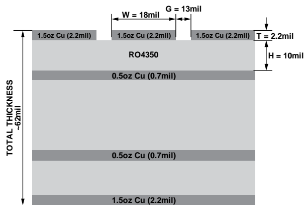
Figure 23. ADRF5019-EVALZ Stack Up
