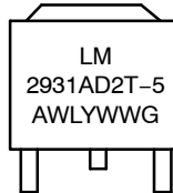
D2PAK D2T SUFFIX CASE 936
