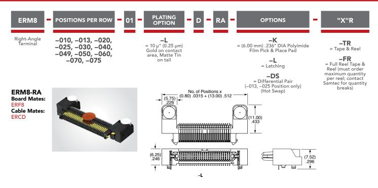
View complete specifications at: samtec.com?ERM8-RA
