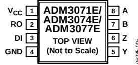
Figure 5. ADM3071E/ADM3074E/ADM3077E Pin Configuration
