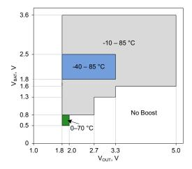
Figure 11-10.  $L_{\mbox{\footnotesize{BOOST}}}$  values over  $V_{\mbox{\footnotesize{BAT}}}$  and  $V_{\mbox{\footnotesize{OUT}}}$
