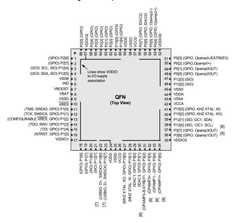
Figure 2-5. 68-pin QFN Part Pinout<sup>[9]</sup>
