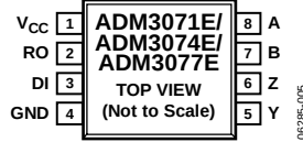
Figure 5. ADM3071E/ADM3074E/ADM3077E Pin Configuration
