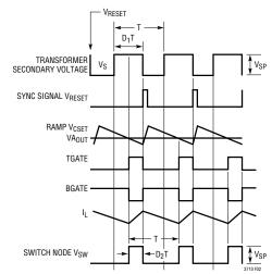
Figure 2. Leading Edge Modulation, Trailing Edge Synchronization
