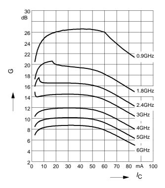
Power gain  $G_{ma}$ ,  $G_{ms} = f(V_{CE})$
