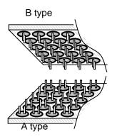
Fig.4-2 ホルダーを重ね合わせる HolderA(B) superpose on HolderB(A).
