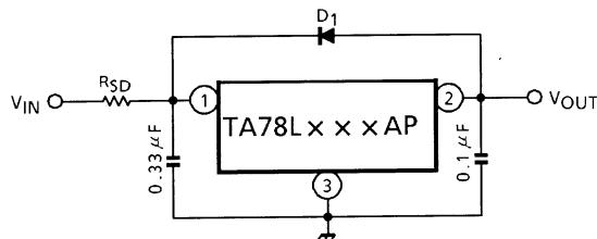
D<sub>1</sub> : IC protective diode
