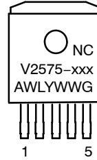
D 2 PAK D2T SUFFIX CASE 936A
