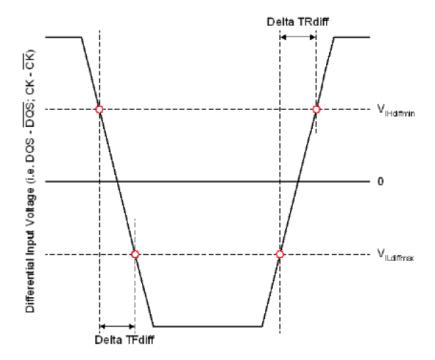
Differential Input Slew Rate Definition for DQS, DQS# and CK, CK#
