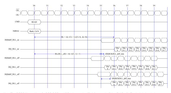
Note: The tDQSCK is used here for DQS, DQS, and DQ to have a simplified diagram; the DLL\_off shift will affect both timings in the same way and the skew between all DQ, DQS, and  $\overline{DQS}$  signals will still be tDQSQ.
