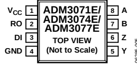
Figure 5. ADM3071E/ADM3074E/ADM3077E Pin Configuration
