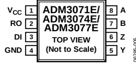
Figure 5. ADM3071E/ADM3074E/ADM3077E Pin Configuration
